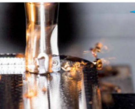
Schuppen mit hohen Vorschüben und selbst bei langer Auskrakung präzisionsicher mit BNGX10-Wendeschneidplatten von Daner Pramet.
